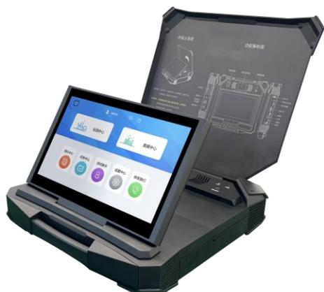
HN-PERS-F800便携式毒物拉曼检测仪是一款基于表面增强拉曼光谱（SERS）技术和增强试剂制备技术所开发的血液中毒物检测仪器，可为毒物致死方面的热点难点问题提供创新性的解决方案。针对公安理化检测需求，内置对应的血液毒物数据库和分析算法，配合检测试剂盒，10-15min内即可输出检测结果。仪器采用镁铝合金外壳设计，配备11.6寸大屏幕，操作方便。同时配置打印机，检测完成后可以直接打印检测报告。仪器具备联网功能，在联网的情况下，实时上传数据，以便于系统用于大数据分析。内置视频操作视频，非常适合尚无操作经验人员现场快检。
