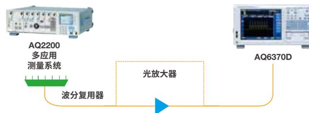
图1: 光放大器测试的典型实验设置
