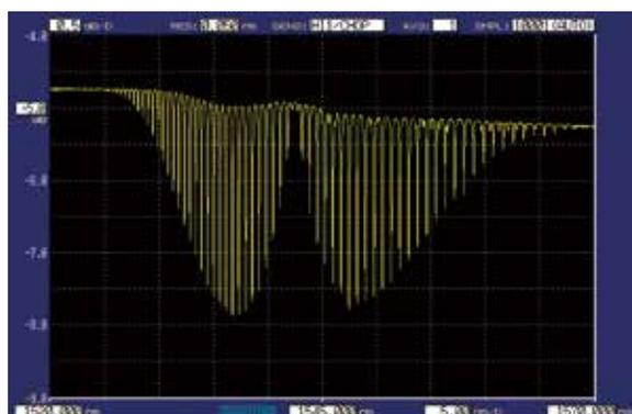
氨化氢H<sub>13</sub>C<sub>14</sub>N的吸收光谱测量(AQ6375B)
